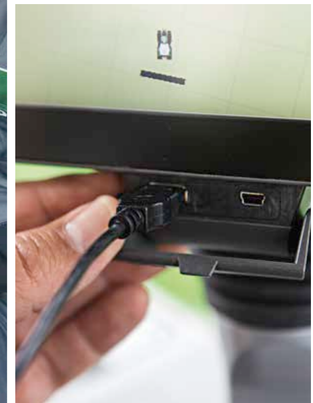
Skifteinnstillingene kan overføres til andre Fendt-traktorer ved hjelp av USB-porten. Ladeporten for mobiltelefoner er også veldig praktisk.
